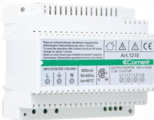
Alimentador para sistema de 2 fios necessário para alimentar o posto externo (bornes L1 - L1) e a coluna montante (bornes L2 - L2). Equipado com 1 borne para a terminação da linha art. 1216. Voltagem de entrada 110-240 V AC. Compatível com unidade áudio/vídeo art. 4681 e 1621 VC e unidade áudio art. 1621. Dimensões 106x89x62 mm (6 módulos DIN).
