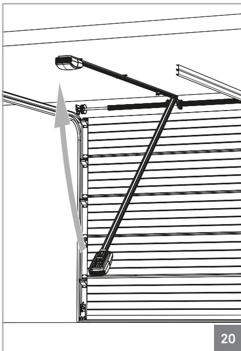
**04** • Suba o motor até que a calha fique nivelada horizontalmente.
