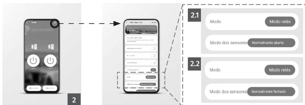
⚠ Caso não apareçam todos os modos apresentados acima, remova o dispositivo SHUTTER da aplicação e volte a registá-lo. Simplesmente atualizar o dispositivo não vai resolver a situação.
